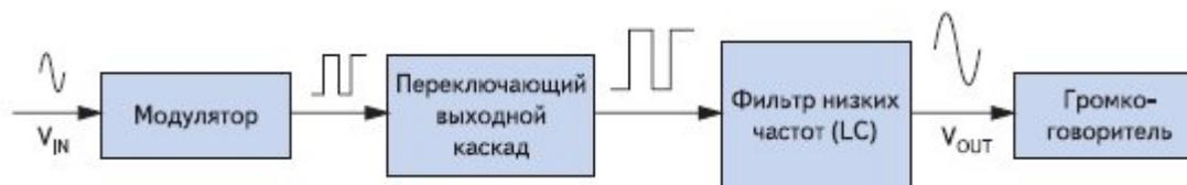
Рис. 2. Блок-схема усилителя класса D без обратной связи
