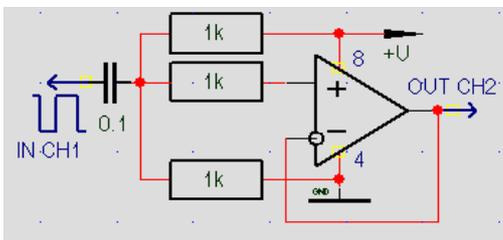
Проверка разных ОУ в режиме повторителя напряжения ( $G=1$ ).
