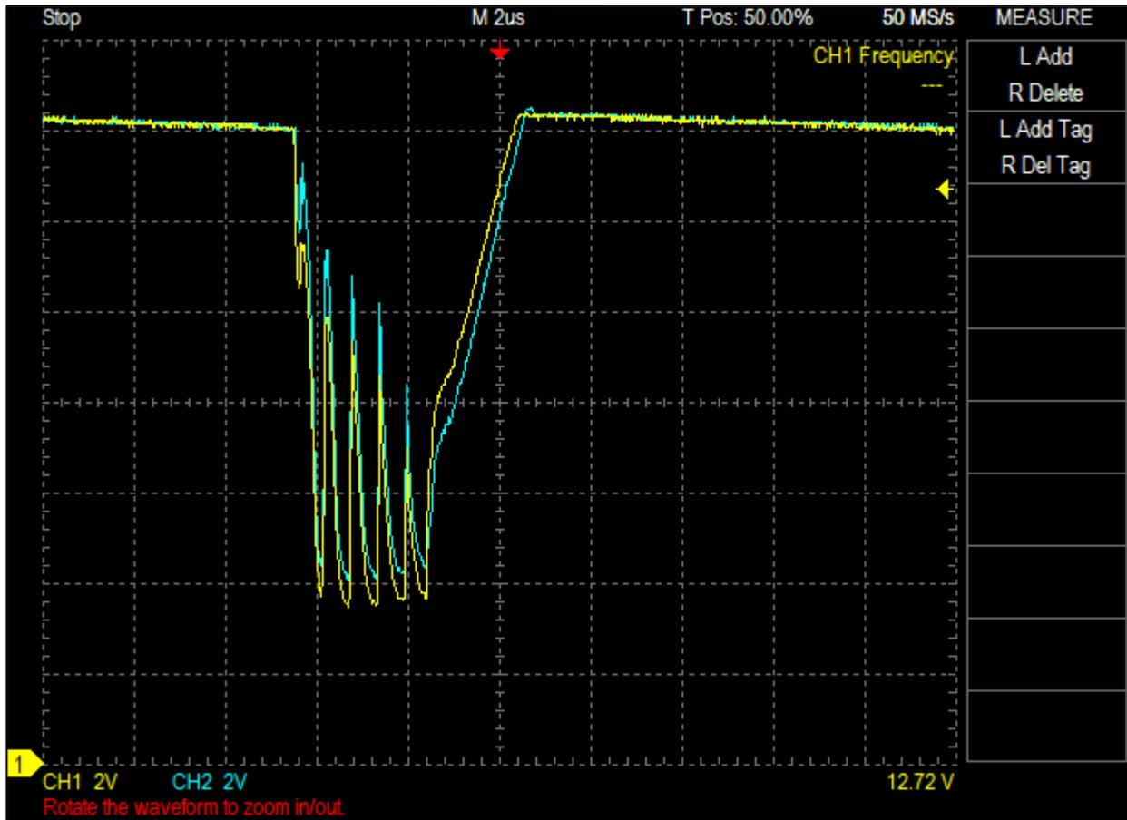
А тут тест осциллографа на совпадение выхода входу, сигнал с одной точки (полное совпадение).
