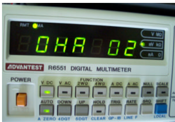
図 16. 機器上での GPIB アドレス設定
