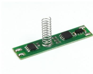
Данное устройство представляет собой сенсорный бесконтактный выключатель светодиодных лент с функцией плавного изменения яркости. Значение уровня яркости после выключения светильника сохраняется во внутренней памяти.
