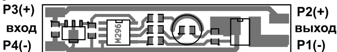
Димер устанавливается в алюминиевый светодиодный профиль в разрыв между источником питания и нагрузкой.
