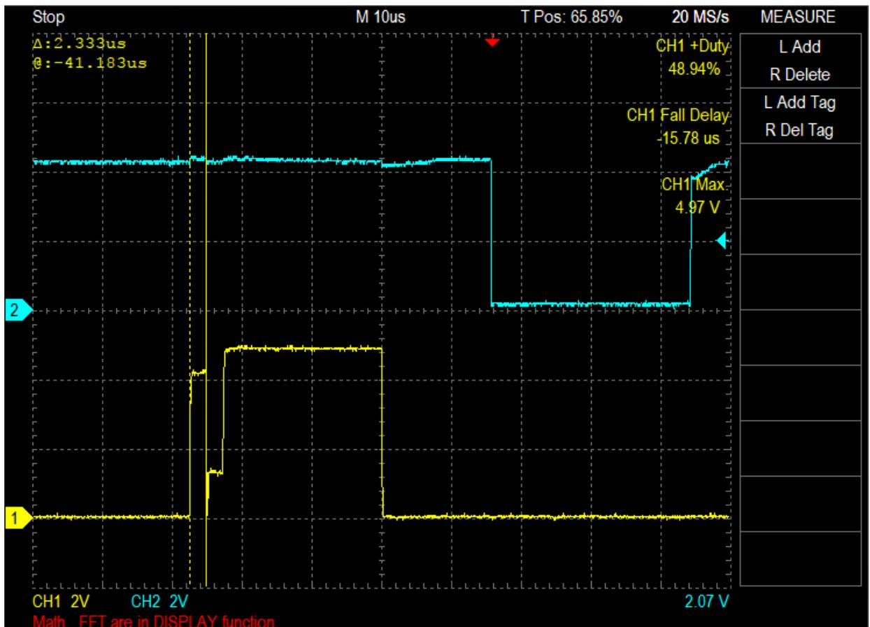
Похоже импульс 2.3мкС идет с контроллера, далее такой же длительности пауза=0 и шина отпускается, если датчик выдает 1, то как на картинке, а если 0, то два импульса коротких, вот так:
