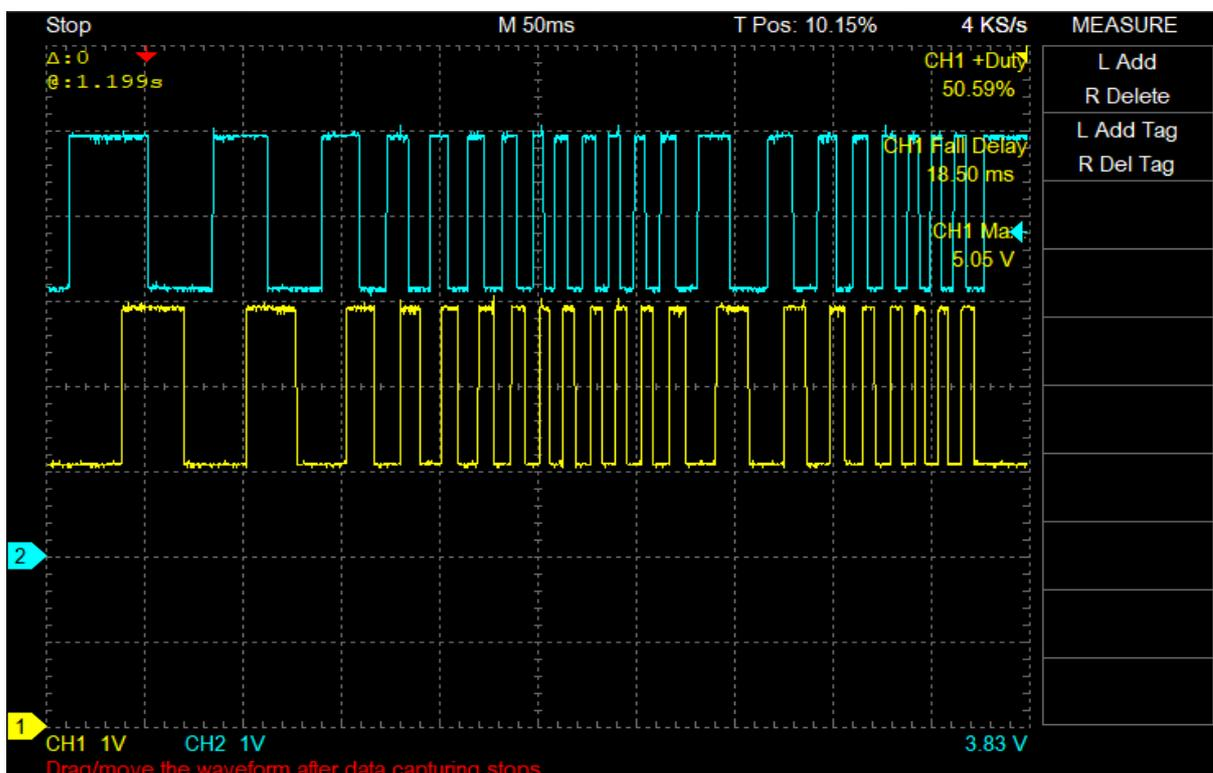
Всего комбинаций кода около 200 при полном обороте колеса, сбился со счета. Можно считать опрос датчика при помощи МК вполне успешным, можно его применять в качестве оптического энкодера в самоделках. Дребезга нет, считывание стабильное.
