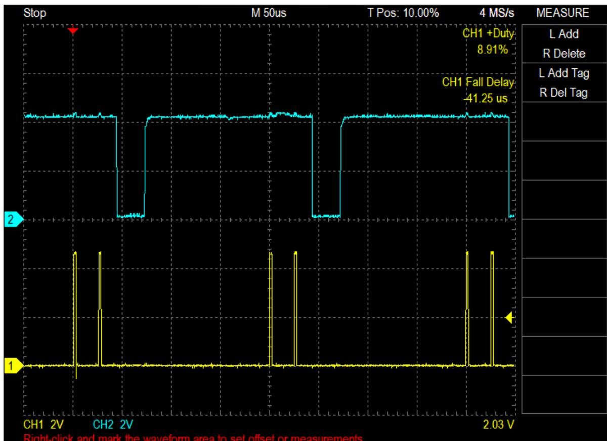
2 канал - на катоде светодиода. Питание +5В. Падение на светодиоде около 1,2В в импульсе.
