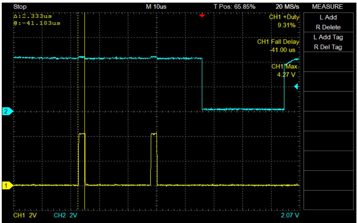
Так же выгидит сигнал с контроллера, когда датчик оторван вообще, с его выхода 0-уровень без импульсов.
