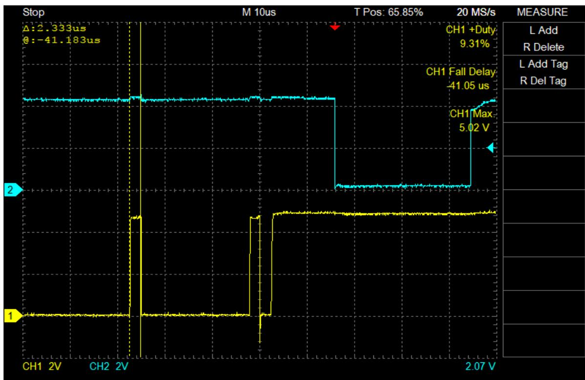
Все так же, после первого импульса датчик линию не отпускает, а отпускает после второго импульса и до следующего первого импульса другого опроса. Причем подтяжка похоже в этом случае со стороны датчика, т.к. уровень сигнала после резистора на нем больше, вот так:
