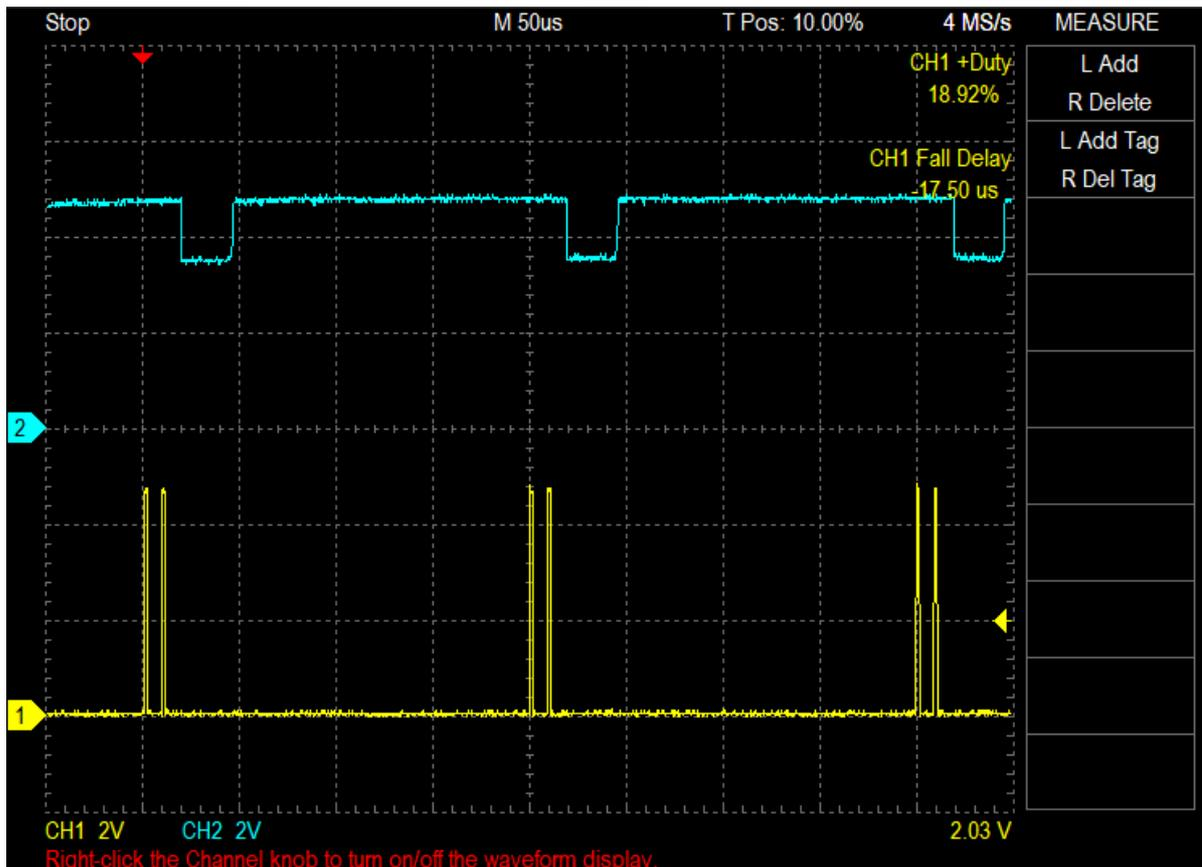
Сигналы похожи, опрос 200мкс, но интервал между импульсами меньше в 2 раза, импульсы с промежутком 10мкс, а не 25мкс. Оно же растянуто:
