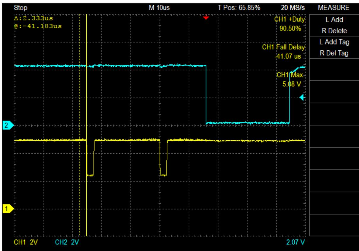
Т.е. импульсы формируются контроллером, сначала отпускает шину на 2,3мкс, затем притягивая ее к общему на то же время, а затем отпускает и смотрим уровень. Если высокий уровень после первого импульса, то вращение на себя, если после второго, то вращение от себя. Вот примерно такой опрос по однопроводному интерфейсу. Надо опробовать на МК.
